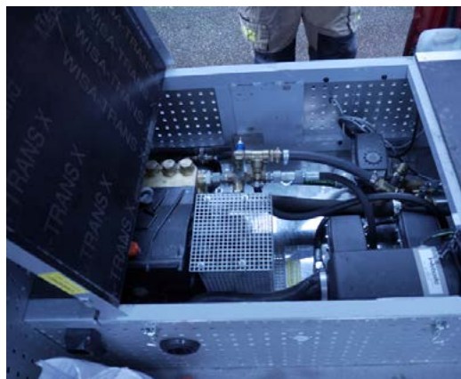
Rys. 2. Urządzenie COBRA zasilane z przystawki przekazania mocy typu PTO
