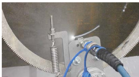
Rys. 10. Końcówka służąca do wycinania i chłodzenia otworów o ustalonej wielkości
