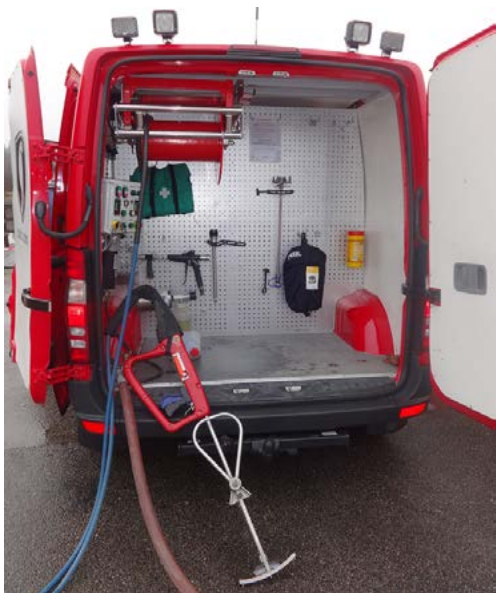
Rys. 1. Urządzenie COBRA zamontowane w pojeździe pożarniczym
