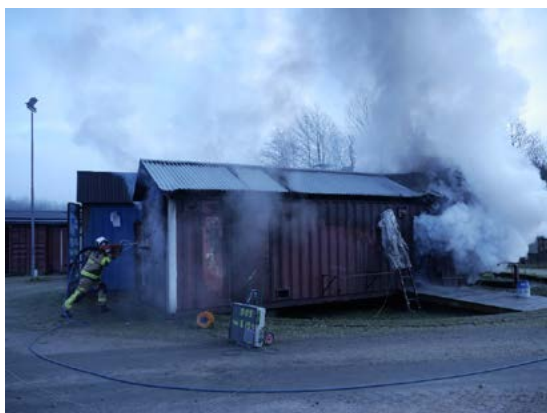
Rys. 7. Gaszenie z przebiciem przez blaszane drzwi pomieszczenia z płonącym olejem
